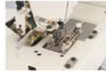
ZJ1508PRD 4 iğne çift merdaneli kemer zincir dikiş makinesi
